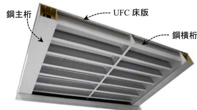
図 UFC床版合成桁
