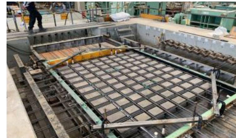
写真 ワッフル型UFC床版の型枠
