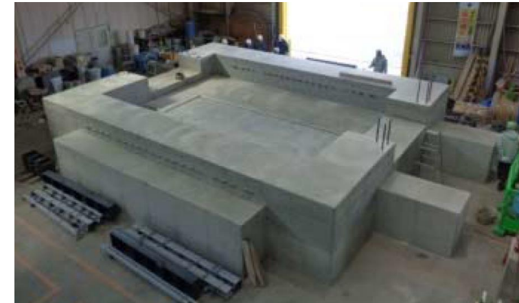
写真 ワッフル型UFC床版の製作架台
