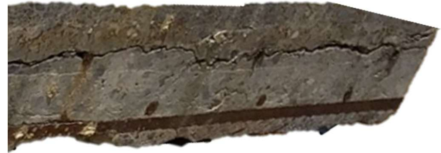
(例1) P-1 下面鉄筋ひび割れなし (上面鉄筋ひび割れあり)
