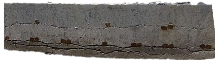
(例2) O-2 下面鉄筋ひび割れ両面
